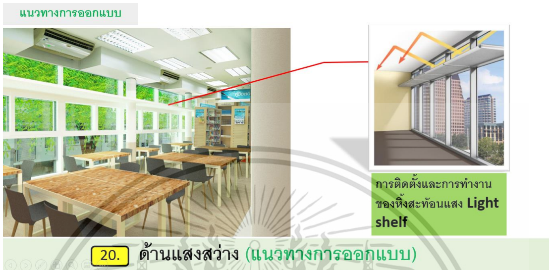
ภาพที่ 4.60 การติดตั้งและการทำงานของหิ้งสะท้อนแสง Light shelf
