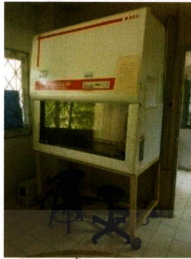
รูปที่ 2 - 21 ตู้ปลอดเชื้อ (Biological Safety Cabinet)
