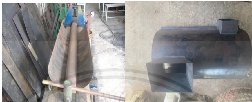
รูปที่ 3.10 การม้วนเหล็กแผ่นและการทำช่องป้อนและทางออกของฝักข้าวโพด
