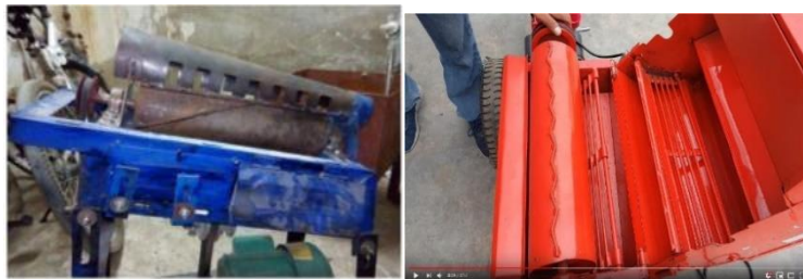
รูปที่ 2.8 กลไกลูกกะเทาะเหล็กเส้นม้วนเป็นเกลียว [6]
