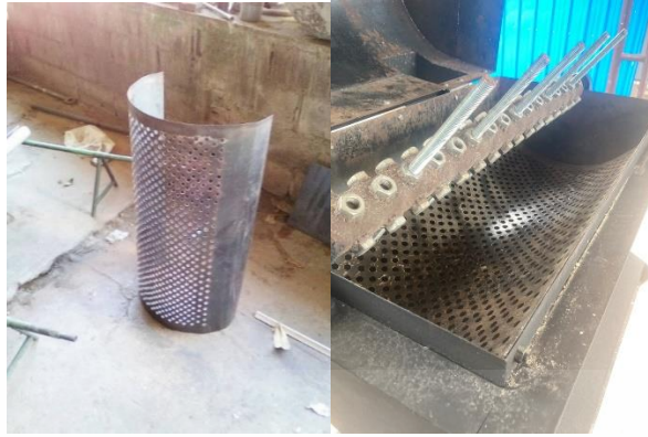
รูปที่ 3.12 เป็นการทำให้และติดตั้งตะแกรงรองเมล็ด
