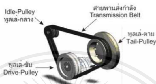
รูปที่ 2.27 หลักการทำงานสายพานส่งกำลัง [15]
