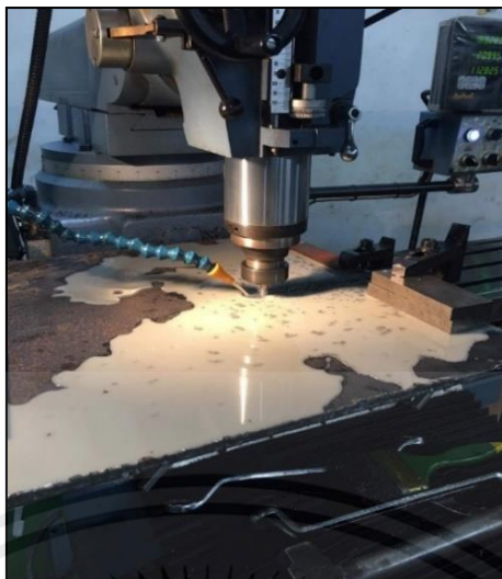
รูปที่ 3.11 ตัดแผ่นรับแรงให้ได้ขนาด 300 \times 300 \text{ mm}^2
