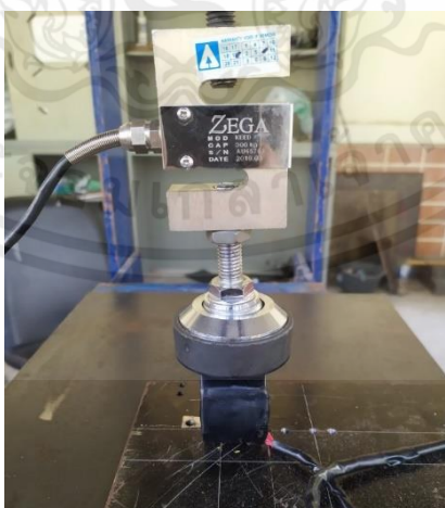
รูปที่ 3.16 การสอบเทียบโหลดเซลล์วงแหวนในแนวตั้ง
