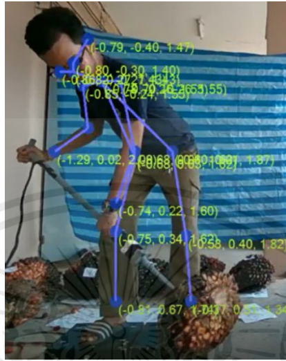
รูปที่ ข.2 การทดสอบยกกะลายปาล์ม
