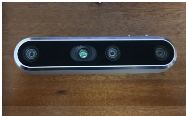
รูปที่ 3.6 กล้อง Depth Camera ยี่ห้อ Intel RealSense รุ่น D455
