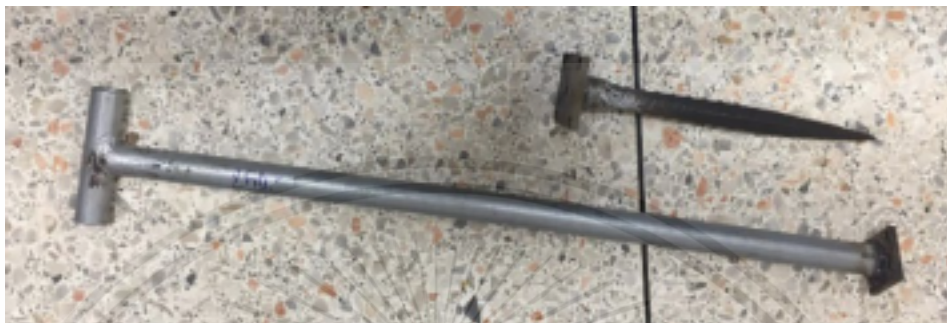
รูปที่ 3.4 เหล็กยกทะลายปาล์มดัดแปลง
