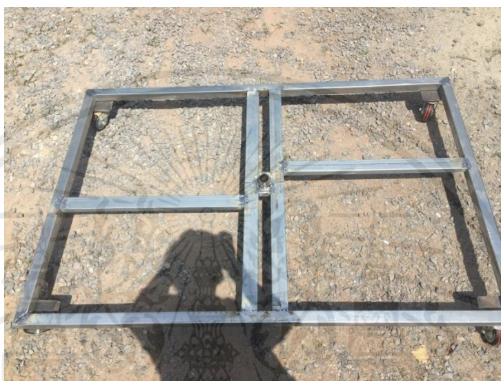
รูปที่ 3.6 โครงสร้างติดตั้งกระจกสะท้อนแสง
