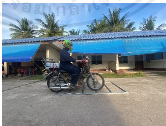
รูปที่ 3.27 ทดสอบแบบวิ่งผ่านลูกระนาดแบบหน้าตัดสามเหลี่ยม
