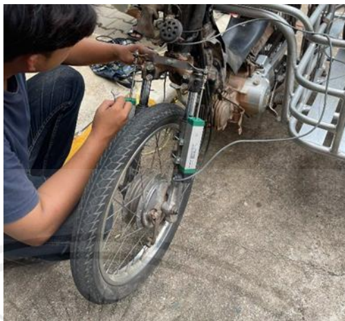
รูปที่ 3.19 ติดตั้ง Linear displacement sensor บริเวณล้อหน้าของจักรยานยนต์
