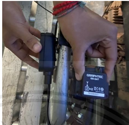
รูปที่ 3.22 ติดตั้ง Acceleration sensor
