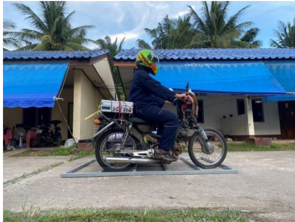
รูปที่ 3.28 ทดสอบแบบวิ่งผ่านลูกระนาดแบบหน้าตัดสี่เหลี่ยม
