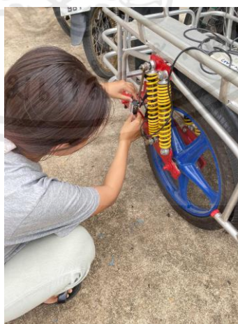
รูปที่ 3.21 ติดตั้ง Laser displacement sensor บริเวณข้างของล้อพวงข้าง
