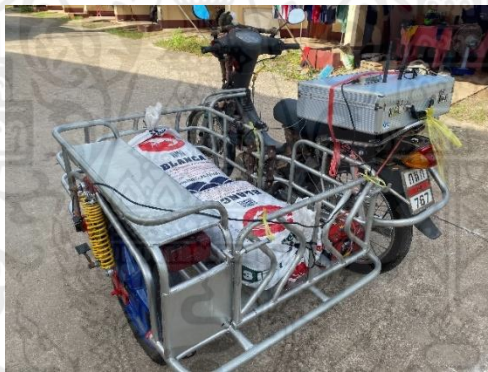
รูปที่ 3.29 รถจักรยานยนต์พวงข้างพร้อมน้ำหนักถ่วงที่ตัวพวงข้าง 100 kg
