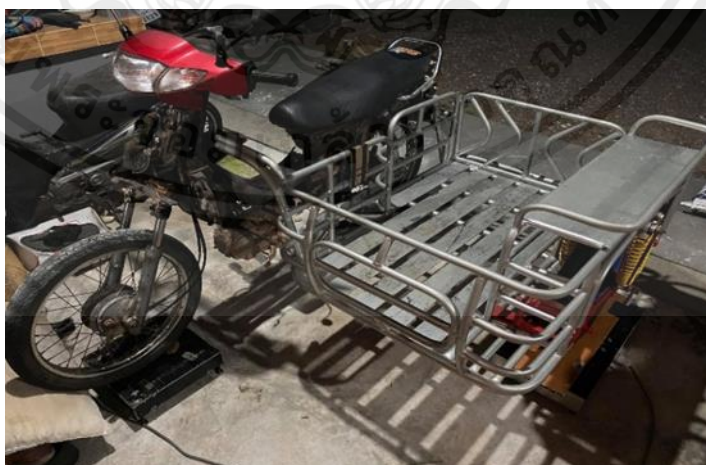
รูปที่ 3.19 การจัดวางตำแหน่งของแผ่นวัดแรงและรถจักรยานยนต์พ่วงข้าง
