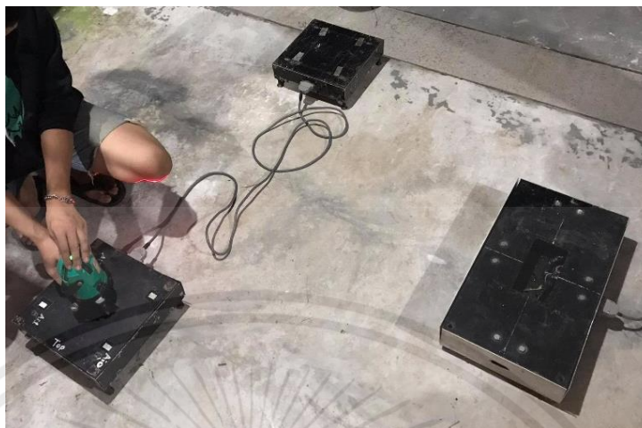
รูปที่ 3.20 การตั้งระดับแผ่นวัดแรงด้วยเครื่องเลเซอร์วัดระดับ
