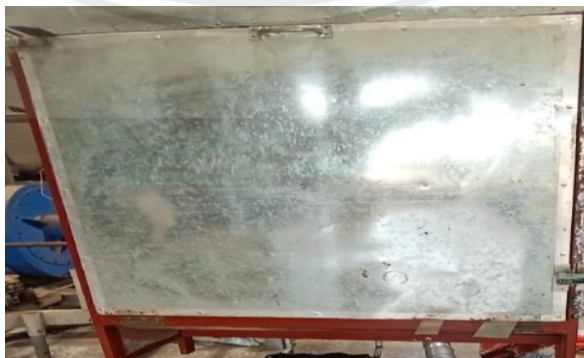
รูปที่ ข.5 ติดตั้งสังกะสีรอบๆตู้อบ
