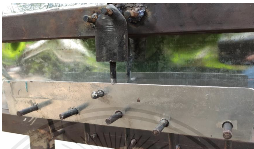
รูปที่ ข.8 ชุดกลไกการปรับองศาของแผ่นบังคับการไหล
