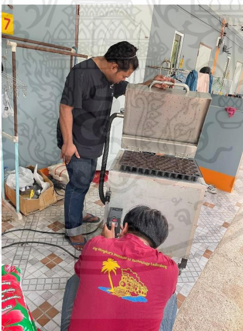
รูปที่ ข.4 ทำการเปิดเครื่องเครื่องหยอดเมล็ดพันธุ์พืช
