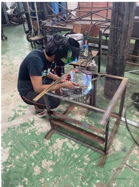
รูปที่ ก.2 การเชื่อมสร้างโครงเครื่องหยอดเมล็ดพันธุ์พืช
