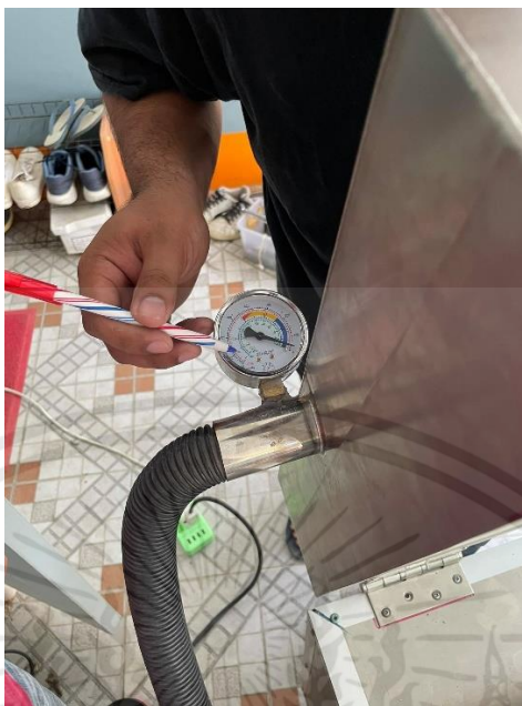
รูปที่ ข.7 เกจวัดแรงดันและแรงดันลมของเครื่องหยอดเมล็ดพันธุ์
