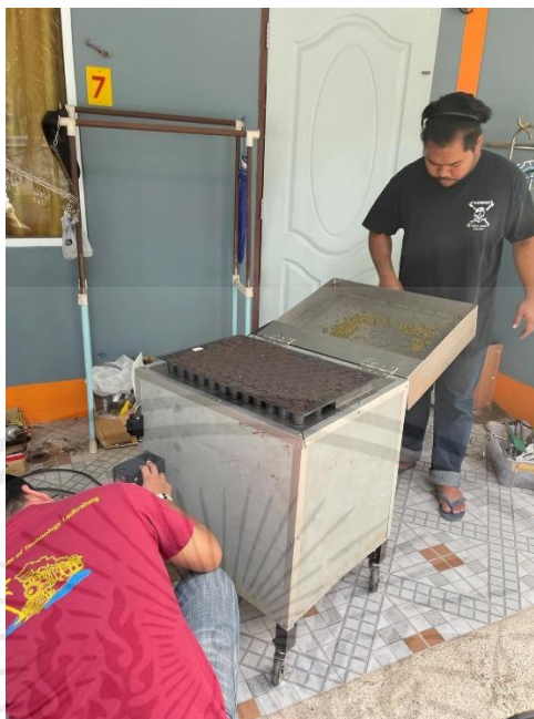
รูปที่ ข.5 ปรับรอบอินเวอร์เตอร์ของเครื่องหยอดเม็ดพลาสติก
