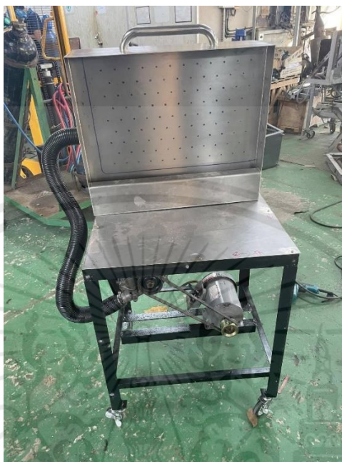
รูปที่ ก.6 ฝาที่เจาะรูสำหรับไว้เครื่องหยอดเมล็ดพันธุ์พืช
