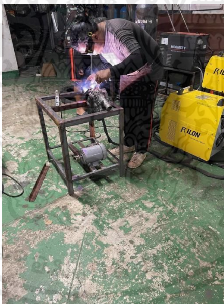
รูปที่ ก.3 ทำการติดตั้งมอเตอร์ไฟและซูเปอร์ชาร์จเจอร์
