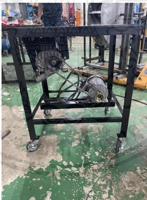
รูปที่ ก.5 หลังจากทำเสร็จแล้วได้ทำการใส่ล้อทำสี่โครงสร้าง
