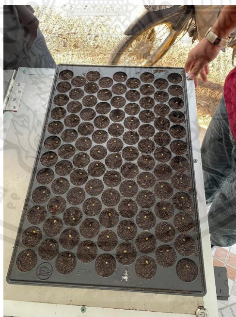
รูปที่ ข.10 เครื่องหยอดเมล็ดพันธุ์พืชลงในถาดเพาะต้นกล้า
