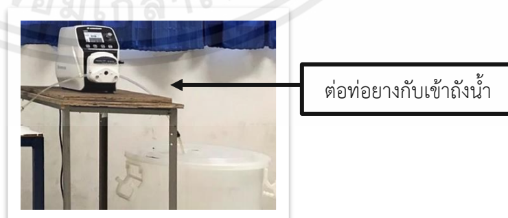
รูปที่3.8 การต่อท่ออย่างเข้ากับถังน้ำ
