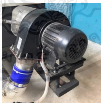
รูปที่ 3.7 พัดลม Blower
