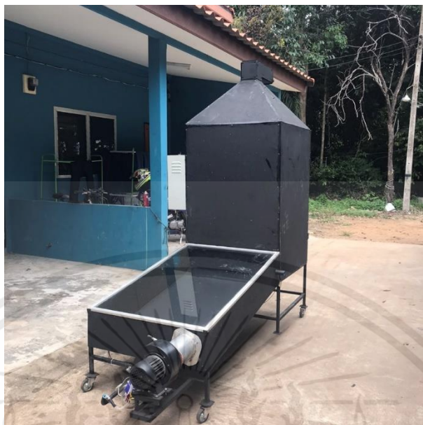
รูปที่ 3.13 ตั้งตู้อบพลังงานแสงอาทิตย์หันไปทิศตะวันออก
