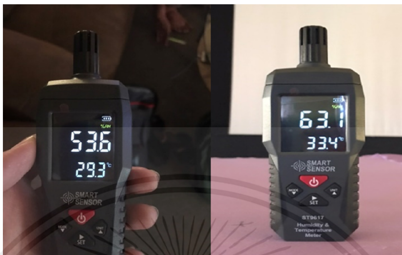
รูปที่ ค.17 เก็บค่าความชื้นและอุณหภูมิของอากาศ
