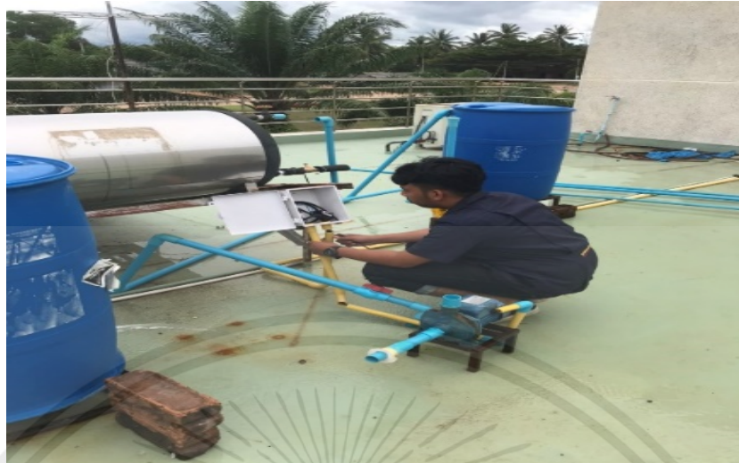
รูปที่ ค.9 ทดสอบสมรรถภาพหัวฉีด
