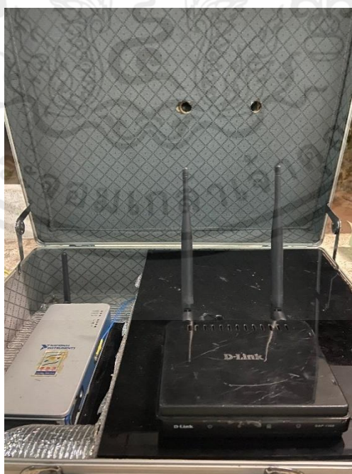
รูปที่ 3.3 Data Acquisition NI CDAQ-9191 และ NI9205
