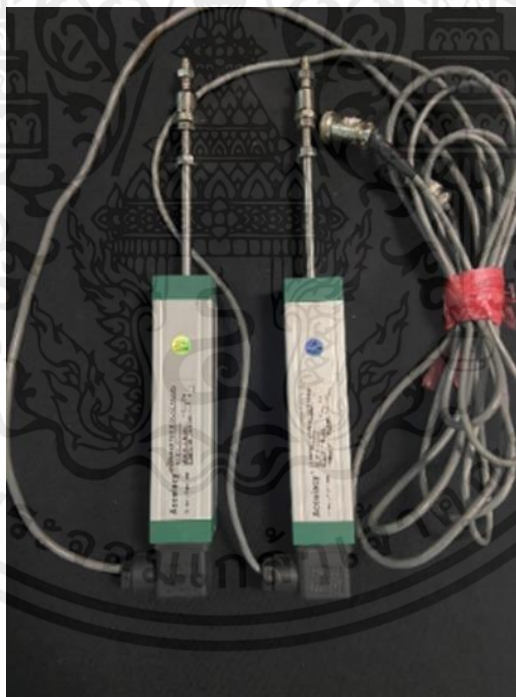
รูปที่ 3.1 Linear position transducer
