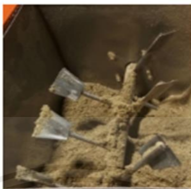
รูปที่ 2.16 ถังผสมที่ใช้ในการคลุกเคล้าอาหารชั้นและอาหารหยาบให้เข้ากัน
