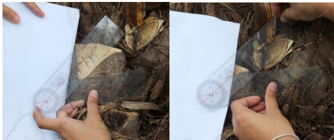
รูปที่ 3.11 ขณะวัดมุมองศาและหาขนาดพื้นที่ชี้วัดทะเลลายปาล์มน้ำมันด้วย Goniometer
