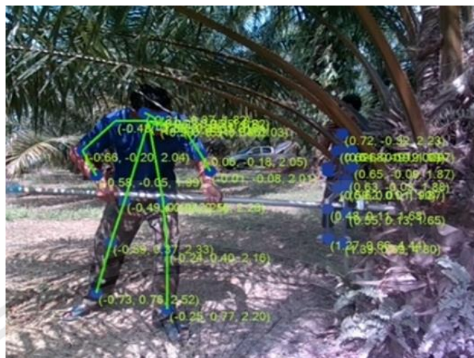
รูปที่ ค.1.1 การแทงทะลายนาล์มของคนชำนาญโดยเครื่องวัดแรงสามแกน
