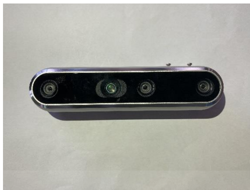
รูปที่ 3.8 กล้อง Depth Camera ยี่ห้อ Intel RealSense รุ่น D455
