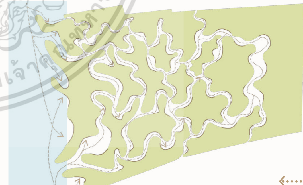
รูปที่ 5.15 ผังแสดงแนวคิดในการดักตะกอน
