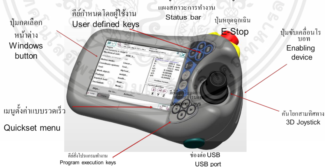
รูปที่ 2.9 อุปกรณ์ที่ใช้ในการเขียนคำสั่งเขียนโปรแกรม (flexpendant)
