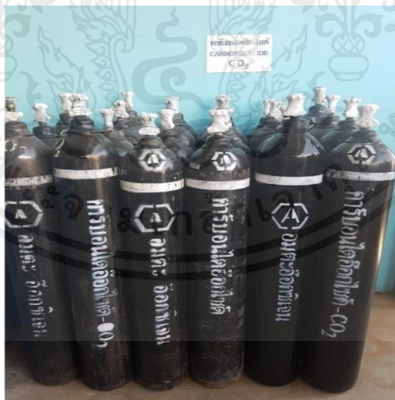
รูปที่ 3.6 ถังคาร์บอนไดออกไซด์
