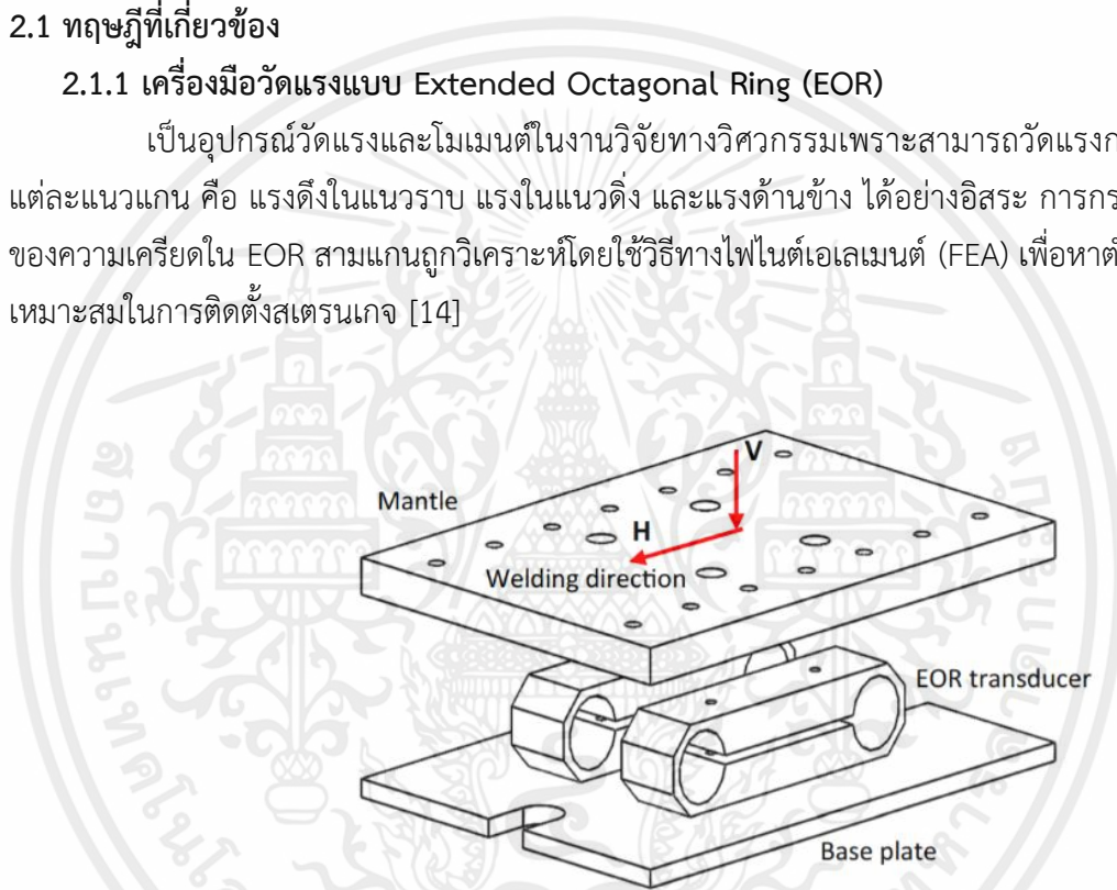
รูปที่ 2.1 แผ่นวัดแรงจาก EOR [14]
