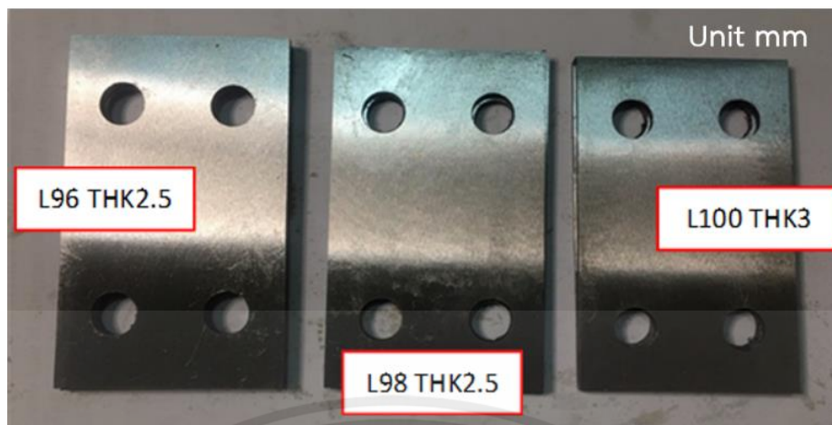
รูปที่ 3.5 แผ่นเหล็กรองรับจุดจับยึด
