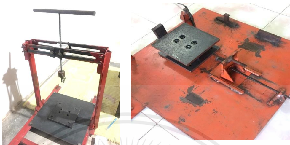
รูปที่ 3.11 (ก) ชุดสอบเทียบแนวตั้ง (ข) ชุดสอบเทียบแนวระดับ
