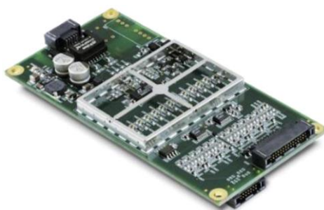
รูปที่ 2.35 Battery Management System (BMS)
