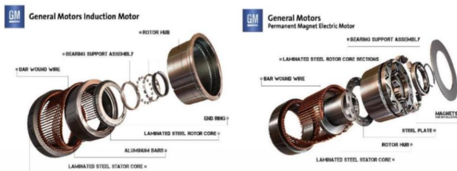
รูปที่ 2.14 Construction of Induction Motor and Permanent Magnet AC Motor
