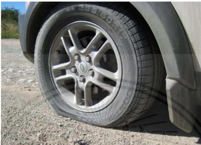
รูปที่ 2.43 แรงดันลมยางต่ำเกินไป
