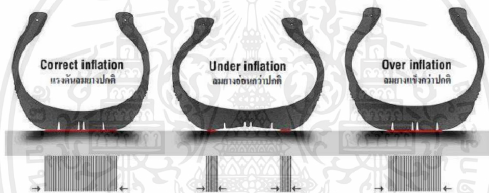
รูปที่ 2.45 ความแตกต่างของผิวหน้ายางที่ยืดเกาะถนน
