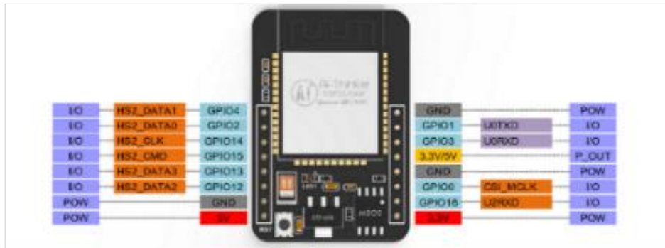
รูปที่ 2.49 สถานะขาของโมดูลกล้อง ESP32
