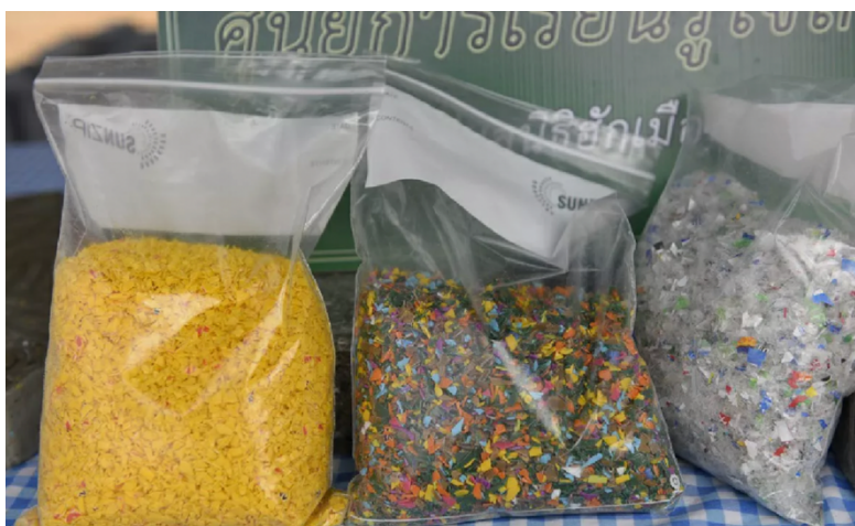
ภาพที่ 8.2 แสดงขยะพลาสติกที่ถูกบดเพื่อนำไปทำอิฐบล็อก ที่มา : Springnews, 2563
