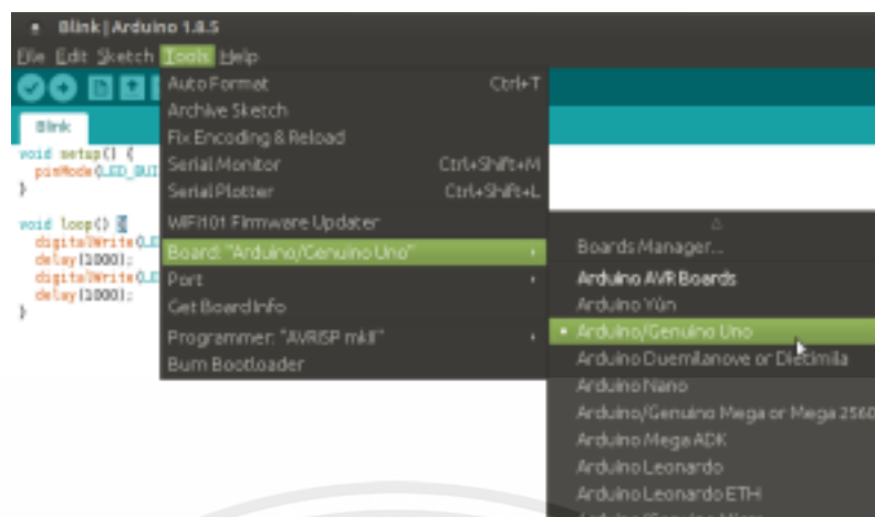
รูปที่ 2.26 เลือกบอร์ด Arduino (ที่มา : https://poundxi.com/ )
