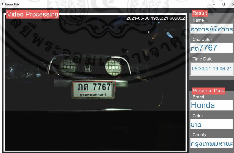
รูปที่ 4.15 มุม 10 องศา ระยะ 250 cm เวลากลางคืน
