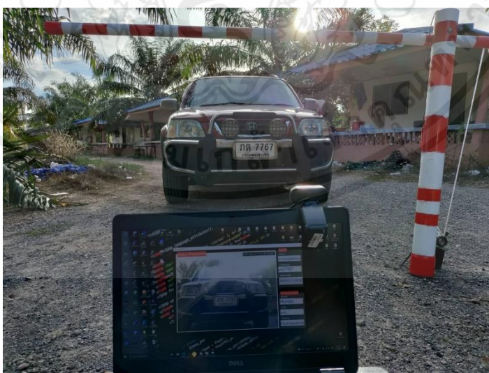
รูปที่ 4.30 การทดสอบการตรวจจับป้ายทะเบียนของรถยนต์
