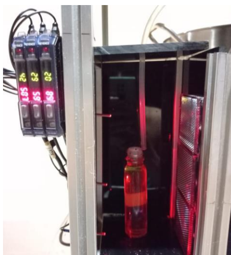
รูปที่ 4.2 ผลการทดลองสถานะของไฟเบอร์ออปติกเซนเซอร์ขวดมีน้ำมัน
