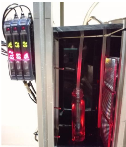
รูปที่ 4.1 ผลการทดลองสถานะของไฟเบอร์ออปติกเซนเซอร์ขวดเปล่า
