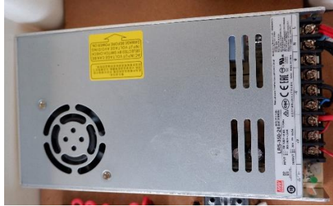
รูปที่ 2.53 แหล่งจ่ายไฟกระแสสลับ
