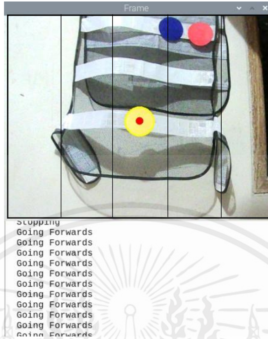
รูปที่ 4.8 การทำงานเมื่อทำการตรวจจับสัญญาณสีเหลือง ตัวหุ่นยนต์เดินหน้า
