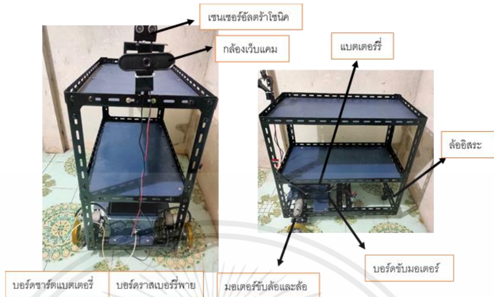
รูปที่ 3.16 โครงสร้างหุ่นยนต์บาร์ติดตามจริงด้านหน้าและด้านข้าง
