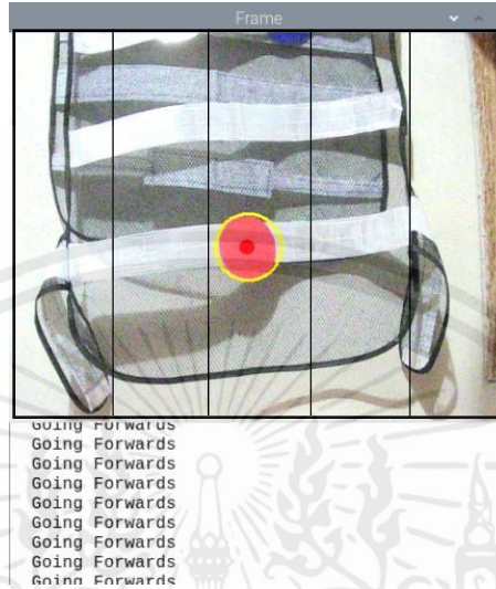
รูปที่ 4.2 การทำงานเมื่อทำการตรวจจับสัญลักษณ์สีแดง ตัวหุ่นยนต์เดินหน้า
