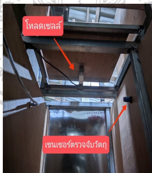
รูปที่ 3.17 การออกแบบจุดชั่งน้ำหนักและจุดกักเก็บ
