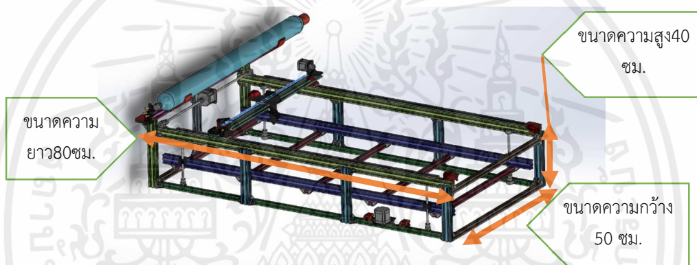
รูปที่ 3.4 โครงสร้างเครื่องแกะลายวงจรอิเล็กทรอนิกส์
