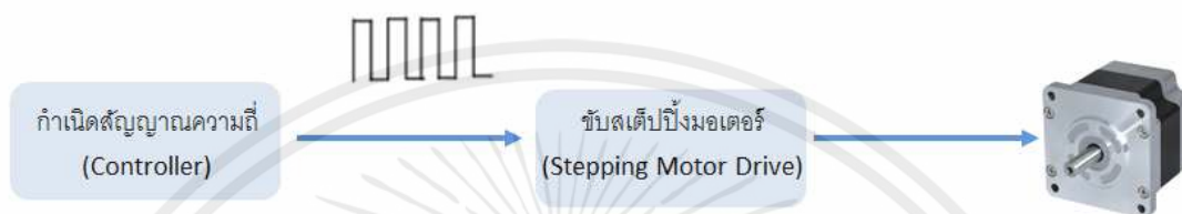
รูปที่ 2.4 หลักการทำงานสเต็ปมอเตอร์(Steptomotor) (ที่มา: https://mall.factomart.com/principle-of-stepping-motor/ )
