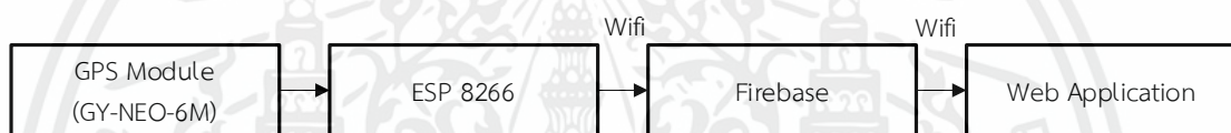
รูปที่ 3.2 บล็อกไดอะแกรมเว็บแอปพลิเคชันระบบติดตามรถโดยสารประจำทาง
