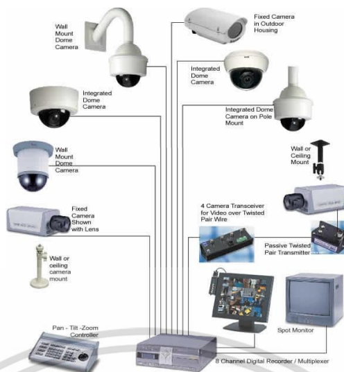
ภาพที่ 6.10 ระบบโทรทัศน์วงจรปิด CCTV การศึกษาระบบเส้นทางสัญญาณภายในโครงการ ที่มา : www.zmodo.com (สืบค้นวันที่ 9 พฤศจิกายน 2563)
