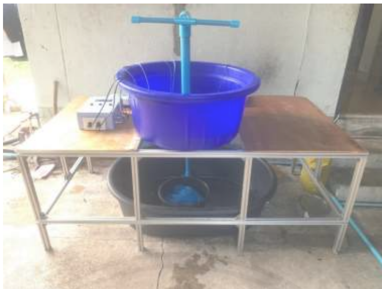
รูปที่ 3.11 โครงสร้างของเครื่องเลี้ยงลูกปูม้า
