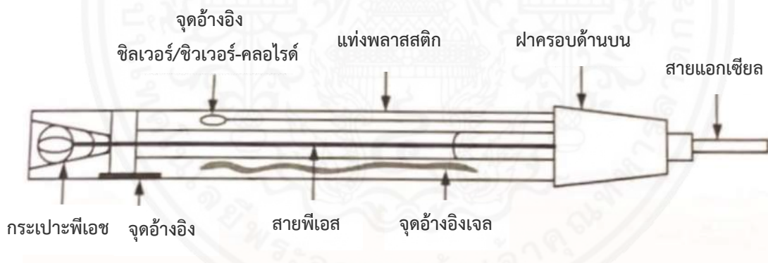
รูปที่ 2.14 เซนเซอร์วัดค่าความเป็นกรด-เบส ที่มีขั้วอิเล็กโทรดเข้าไว้ในชุดเดียวกัน
