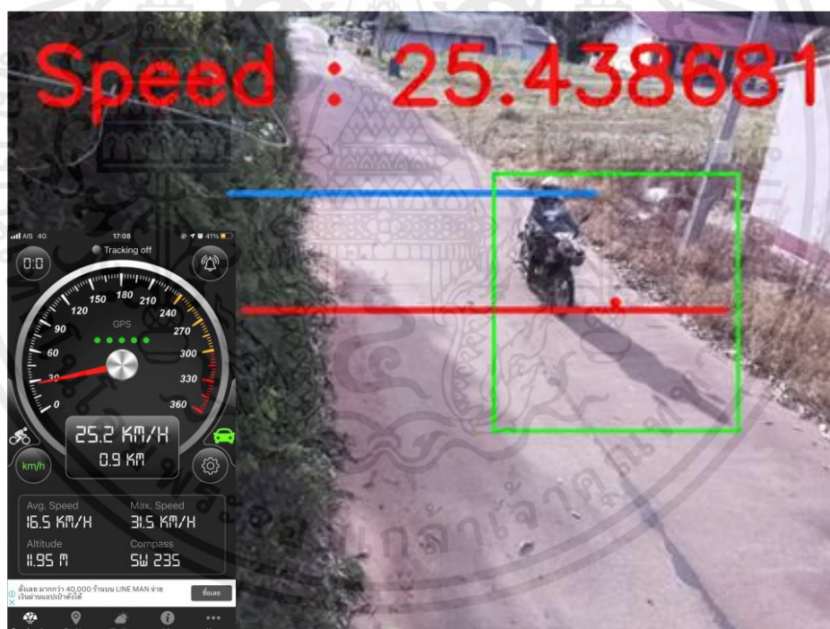
รูปที่ 4.7 ความเร็วรถที่จับได้จากกล้องตรวจจับความเร็ว 25.43 (กม./ชม.)
