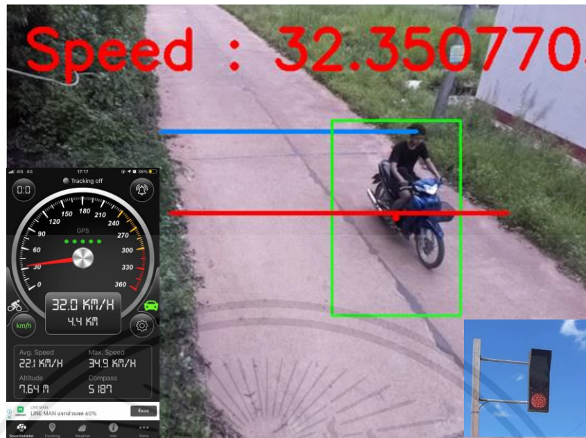
รูปที่ 4.19 การทดลองจับความเร็วรถที่ 32 กม./ชม. (2)
