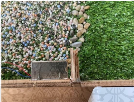
รูปที่ 4.13 กลอนแม่เหล็กไฟฟ้าทำการปลดล็อคประตูรั้วบ้าน
