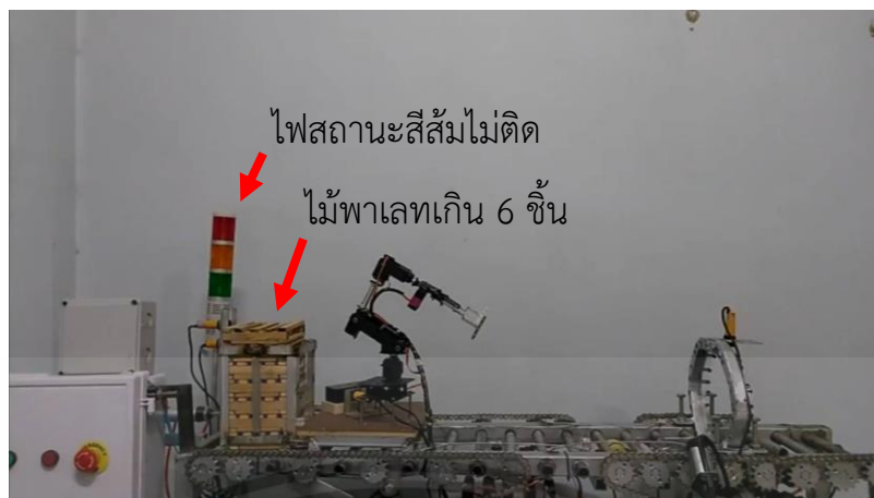
รูปที่ 4.4 ไม้พาเลทเกิน 6 ชั้น ไม่เป็นไปตามเงื่อนไข ไฟสถานะสีส้มจึงไม่ติด
