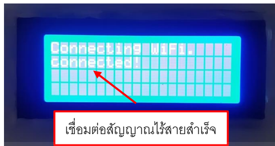
รูปที่ 4.7 การแสดงผลการเชื่อมต่อสำเร็จ ในระยะ 10-60 เมตร โดยหน้าจอ LCD มีการแสดงคำว่า Connected
