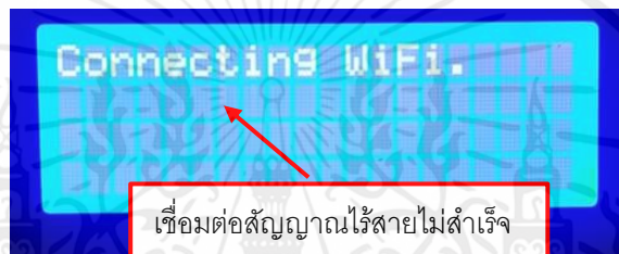
รูปที่ 4.8 การแสดงผลการเชื่อมต่อไม่สำเร็จสำเร็จ ในระยะ 70 เมตร โดยหน้าจอ LCD ไม่มีการแสดงคำว่า Connected
