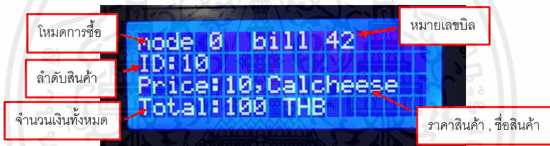
รูปที่ 4.4 การแสดงค่าการสแกนบาร์โค้ดสินค้าที่มีในระบบบนจอ LCD
