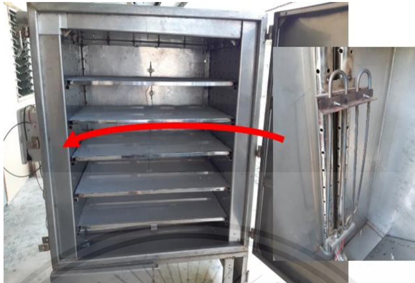
รูปที่ 3.8 ติดตั้งฮีตเตอร์ไฟฟ้า
