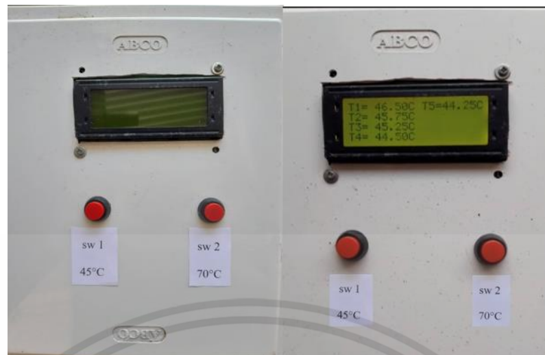
รูปที่ 3.10 การแสดงหน้าตู้ควบคุมอุปกรณ์คอนโทรลต่างๆ
