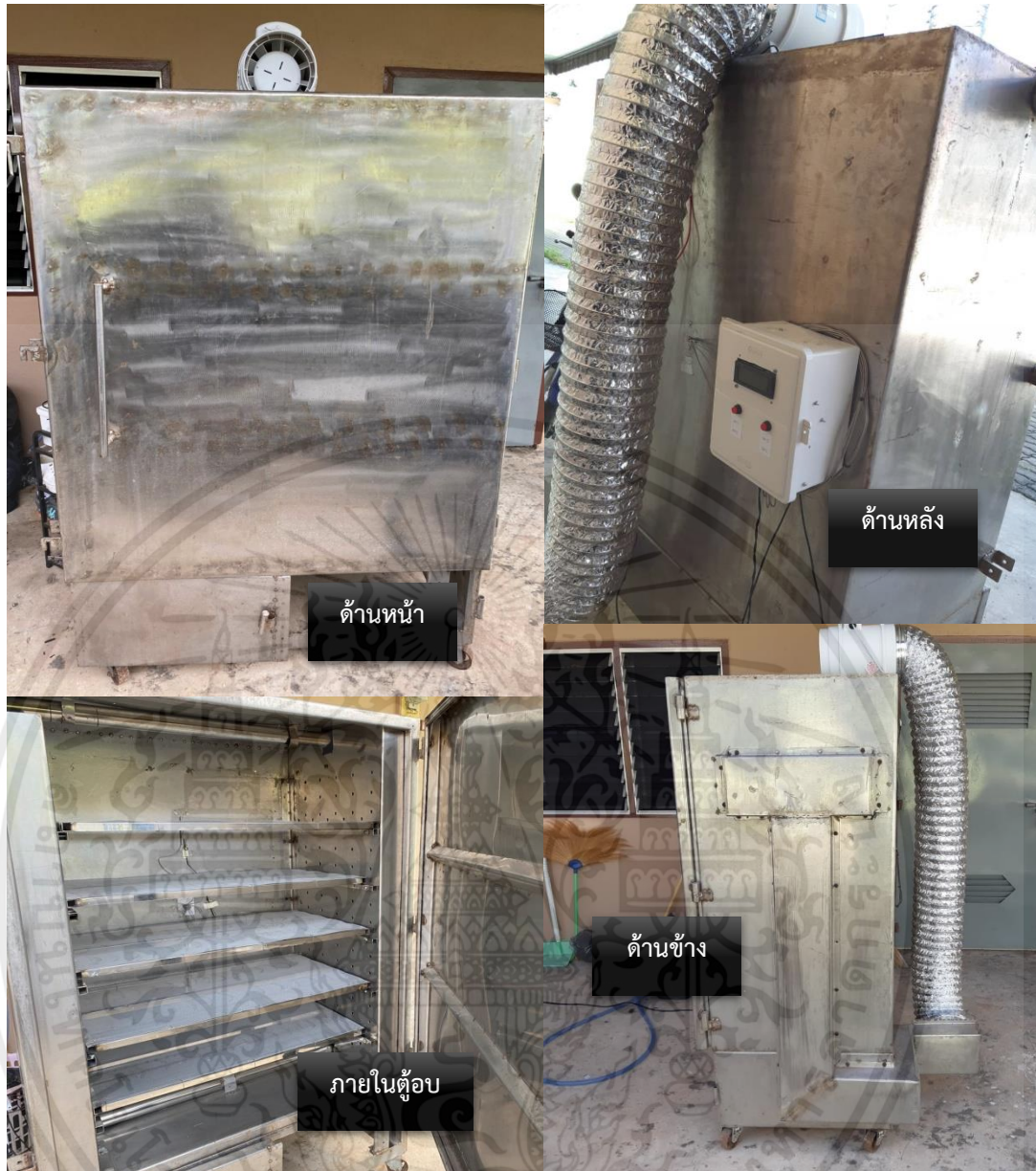
รูปที่ 3.12 ตู้อบกล้วยที่ติดตั้งและทดสอบเสร็จแล้ว
