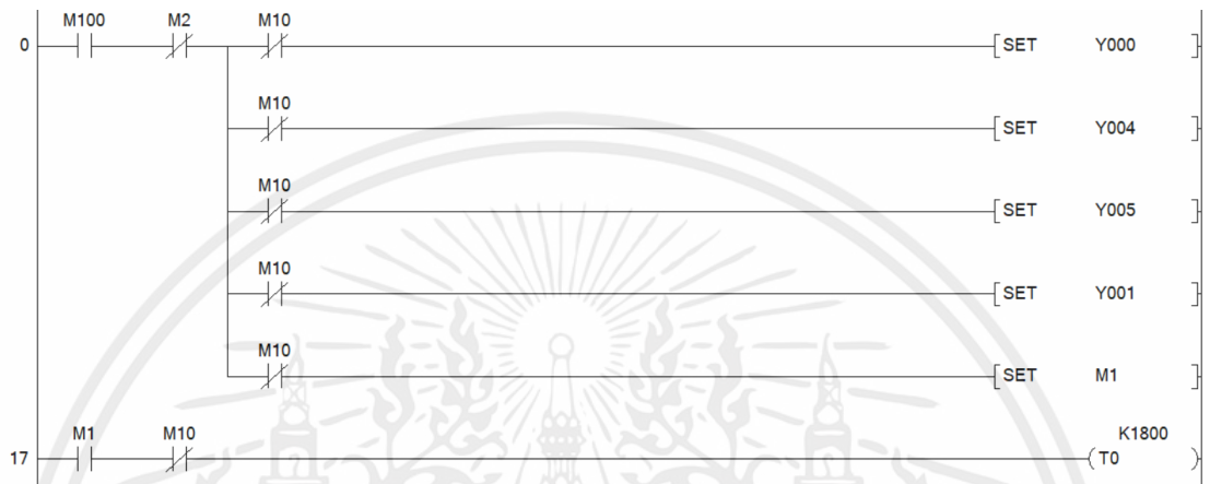
รูปที่ 4.3 โปรแกรมทดสอบระบบฉีดน้ำของเครื่องล้างจานกึ่งอัตโนมัติ
