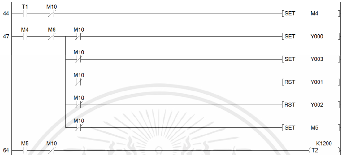
รูปที่ 4.7 โปรแกรมระบบฉีดน้ำ
