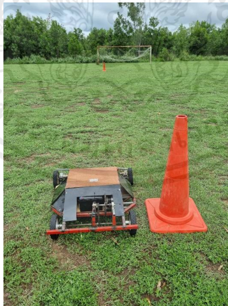
รูปที่ 4.7 ทดสอบความคลาดเคลื่อนของจีพีเอสในระยะทาง 20 เมตร
