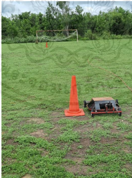
รูปที่ 4.8 ทดสอบความคลาดเคลื่อนของจีพีเอสในระยะทาง 30 เมตร
