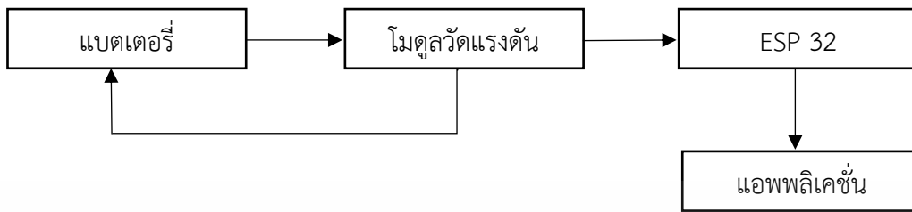
รูปที่ 3.2 บล็อกไดอะแกรมเปอร์เซ็นต์แบตเตอรี่
