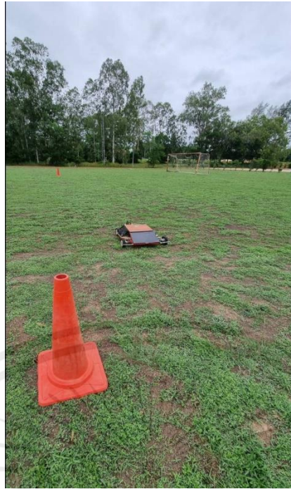
รูปที่ 4.3 ทดสอบการตัดหญ้า 20 ตารางเมตร
