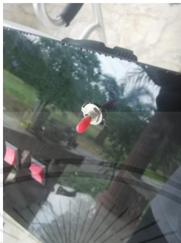
รูปที่ 5ข การเลือกกดสวิทช์เลือกโหมดการทำงานในระบบอัตโนมัติ
