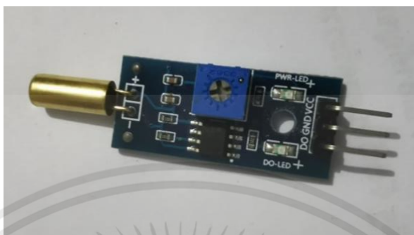
รูปที่ 2.8 โมดูลสวิตช์ตรวจจับการเอียง/สั่น
