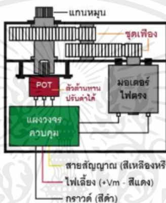
รูปที่ 2.14 ไดอะแกรมการทำงานของเซอร์โวมอเตอร์
