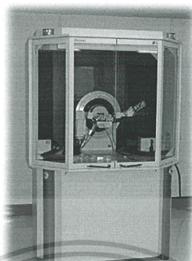
รูปที่ 3.16 เครื่องวัดการเลี้ยวเบนด้วยรังสีเอ็กซ์ ของบริษัท Bruker รุ่น D8
