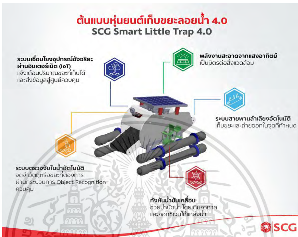
ภาพที่ 2-20 หุ่นยนต์เก็บขยะลอยน้ำ 4.0 (SCG - DMCR Litter Trap) (ที่มา : SCG และกรมทรัพยากรทางทะเลและชายฝั่ง (ทช.))
