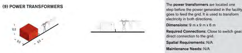
ภาพที่ 3-19 ภาพแสดงขนาด Power Transform (source : Hanif kara)
