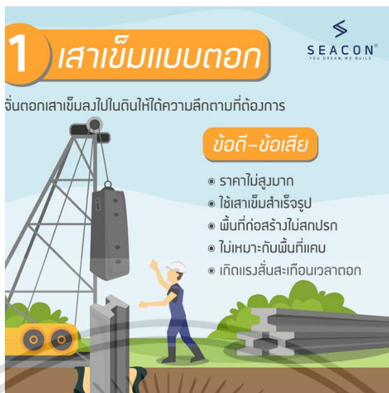
ภาพที่ 7.1 ภาพแสดงกระบวนการทำงานเสาเข็มแบบตอก
