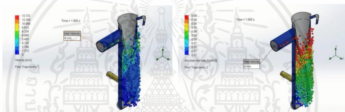
รูปที่ 3.6 ความเร็ว และความชื้นในท่อขนาด 7 เซนติเมตร ในตำแหน่งตรงกลาง
