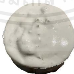
รูปที่ 3.27 เทน้ำยางที่ผสมสารเคมีลงในแม่พิมพ์
