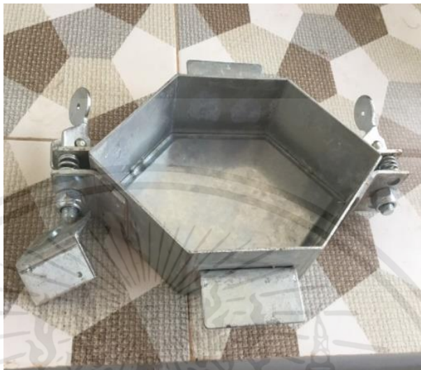
รูปที่ 3.8 บล็อกพิมพ์แบบทกเหลี่ยมแบน มิติ 11.6 x 19.8 x 6 เซนติเมตร
