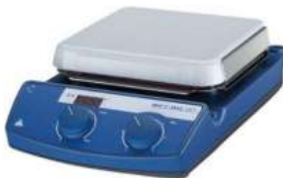
รูปที่ ค.5 เครื่องกวนสารละลายด้วยแท่งแม่เหล็ก [8]
