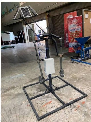
รูปที่ 3.5 แสดงฐานหรือขาตั้งจานรวมแสงพาราโบลิก
