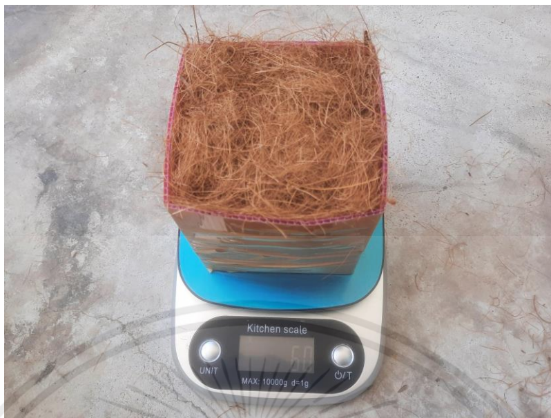
รูปที่ค.2 ปริมาณของเส้นใยมะพร้าวที่ใช้ต่อ 1 ลูกบาศก์ เท่ากับ 60 กรัม
