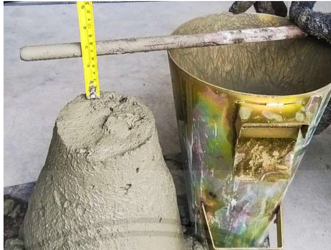
(ค) วัดค่าการยุบตัวของคอนกรีต
